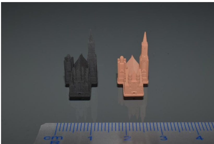
©Lithoz: Stephansdom 3D-gedruckt aus künstlichem Mondstaub im Maßstab 1:7000. Links als Grünteil. Rechts gesintert.
