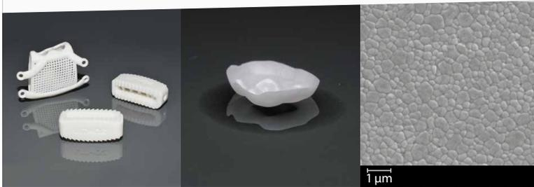
Zirkonoxid wird für Anwendungen eingesetzt, die das Material extrem beanspruchen. Hochwertige Umformtechnik, Ventile, Lager und Schneidwerkzeuge sind nur einige der Anwendungen, die von den mechanischen Eigenschaften von Zirkonoxid profitieren. Die Biokompatibilität von Zirkonoxid erleichtert den Einsatz in medizinischen Anwendungen, wie z.B. bei Dentalanwendungen und als Teil von bleibenden Implantaten.
