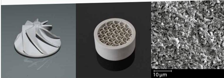
LithaNit 720 enthält eine beta-SiAlON-Keramik. Diese ist durch herausragende Materialeigenschaften, wie hohe Festigkeit, Zähigkeit, Thermoschockbeständigkeit und chemische Beständigkeit gegen Korrosion von Säuren und Basen gekennzeichnet.
