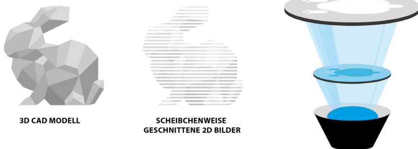
Abb. 2: Schematische Darstellung des Strukturierungsprozesses: Das CAD-Modell (links) wird virtuell in Schichten geschnitten (Mitte) und über eine dynamische Maskenbelichtung („digital light processing“, DLP) wird das Material Schicht für Schicht strukturiert
