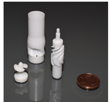
Abb. 3: Teile einer intrakardialen Herzpumpe aus hochreinem Aluminiumoxid (die Bauteile wurden hier für eine bessere Visualisierung 10-fach vergrößert ausgedruckt)
